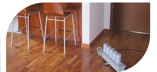
Posa di materassini acustici Misurazione di rumori da calpestio
